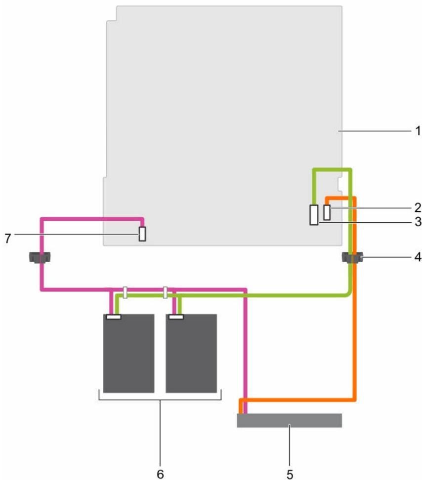
图 29: 将两个 3.5 英寸硬盘驱动器布线至系统板上的 SATA 连接器
