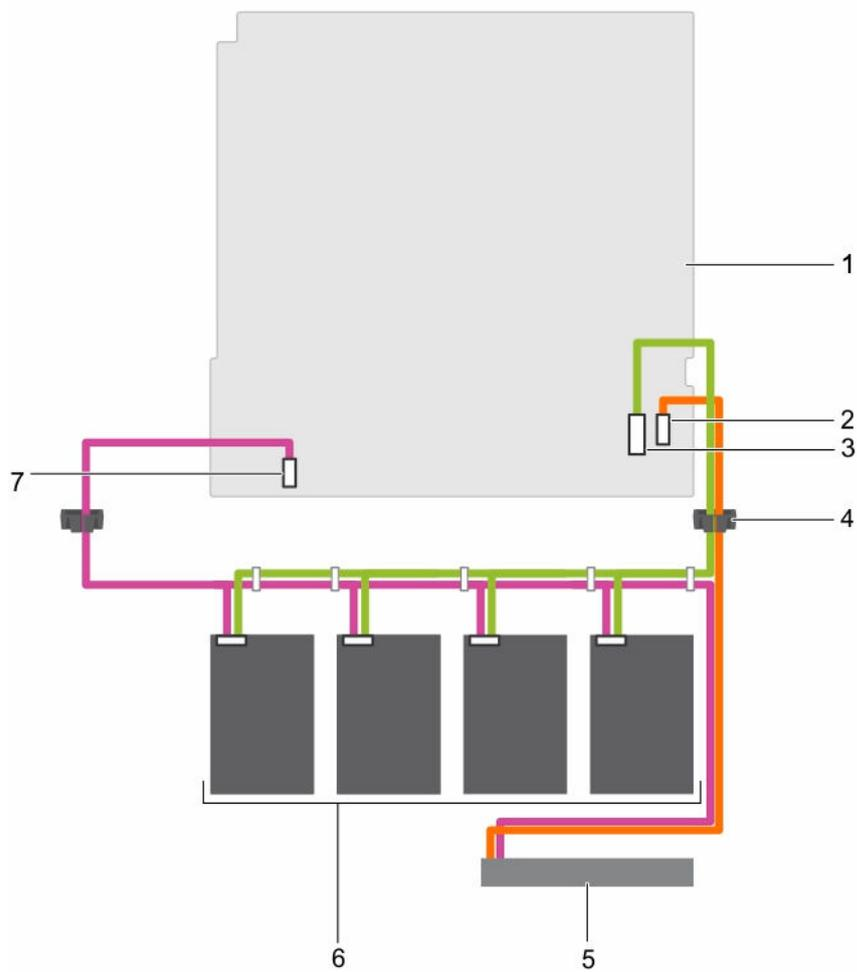
图 27: 将四个 3.5 英寸硬盘驱动器布线至系统板上的 SATA 连接器
