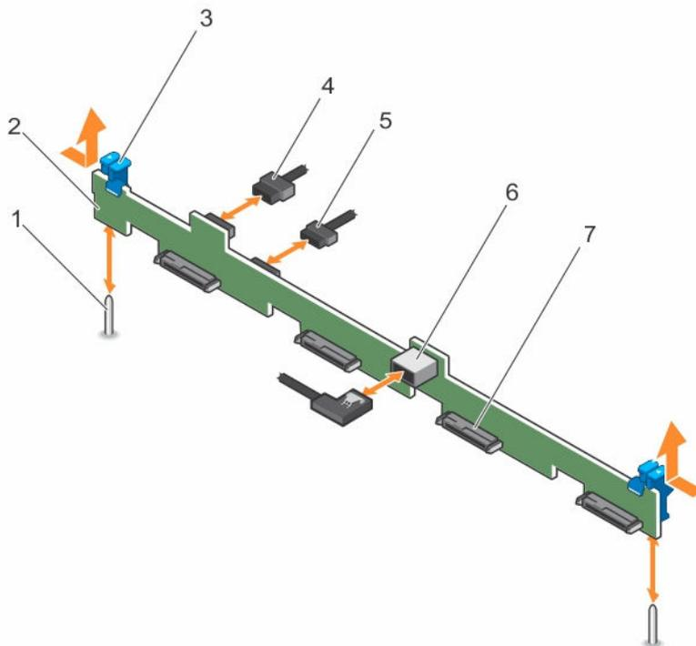
图 46: 卸下和安装四个 3.5 英寸热插拔 SAS/SATA 硬盘驱动器背板
