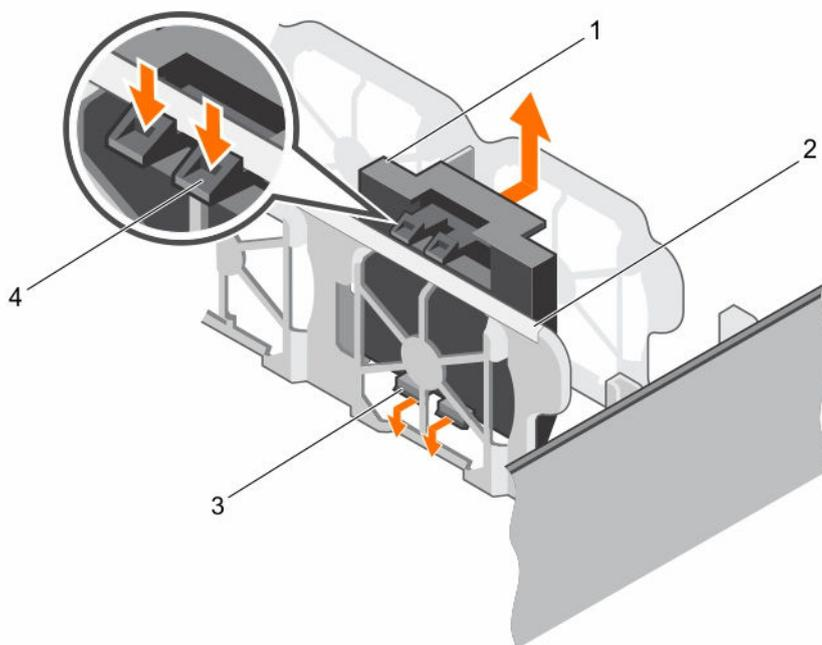
图 31: 卸下和安装冷却风扇挡片
