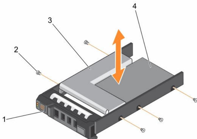
图 25: 在 3.5 英寸热插拔硬盘驱动器托盘中卸下和安装 3.5 英寸硬盘驱动器适配器
