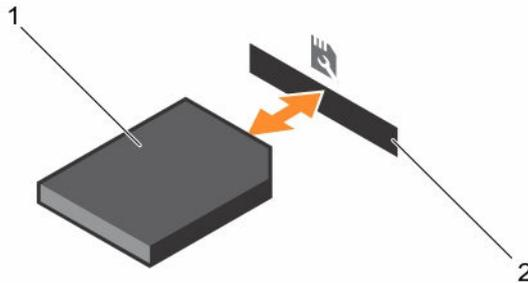
图 37: 卸下并安装 SD vFlash 卡
