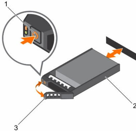
图 22: 卸下和安装热插拔硬盘驱动器托盘
