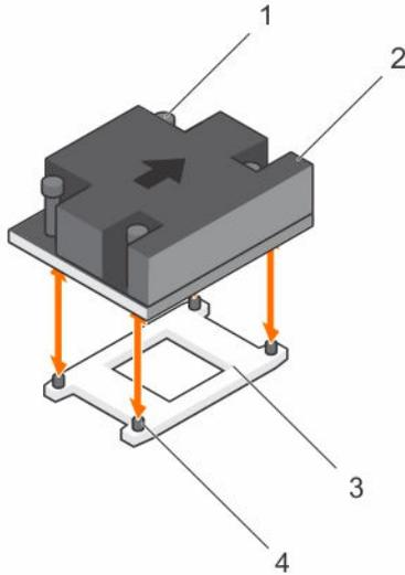
图 39: 卸下和安装散热器
