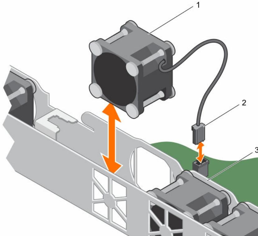
图 32: 卸下和安装冷却风扇
