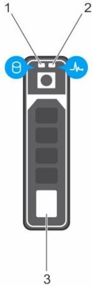
图 5: 热插拔硬盘驱动器指示灯
