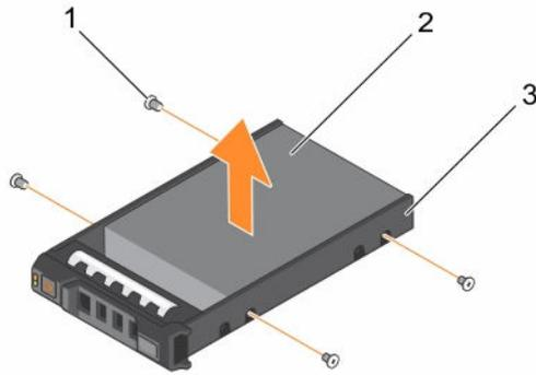
图 23: 在硬盘驱动器托盘中卸下和安装热插拔硬盘驱动器
