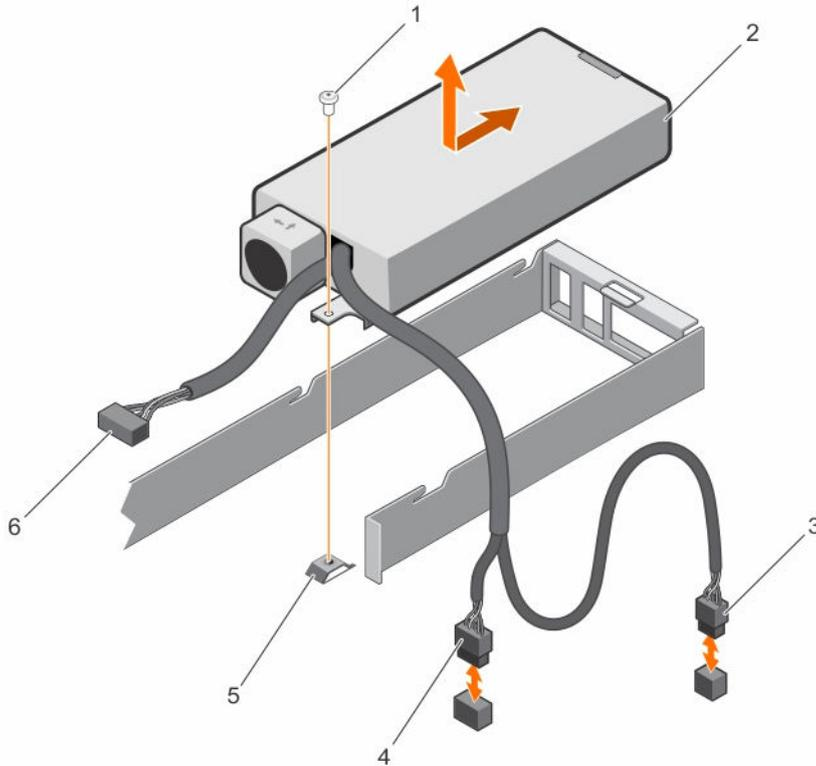
图 43: 卸下和安装有线电源单元
