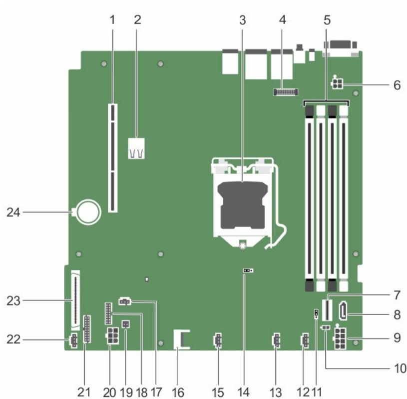
图 55: 系统板跳线和连接器
