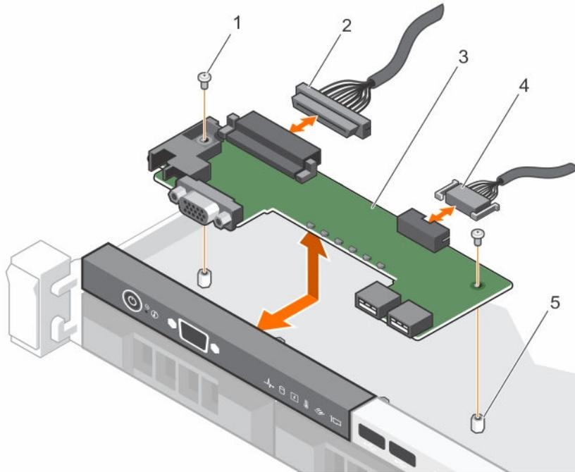
图 51: 卸下和安装 LED 控制面板电路板—四个有线硬盘驱动器机箱
