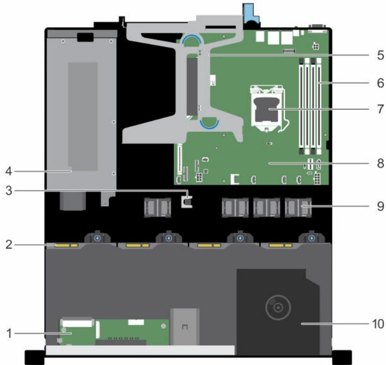
图 12: 系统内部 — 四个 3.5 英寸有线硬盘驱动器系统
