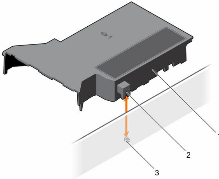
图 15: 卸下和安装冷却导流罩
