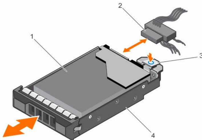
图 20: 卸下和安装有线硬盘驱动器托盘
