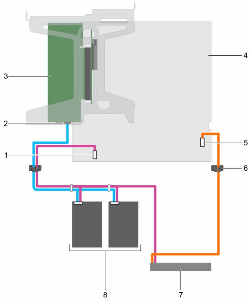
图 28: 将两个 3.5 英寸硬盘驱动器布线到 PERC 卡。
