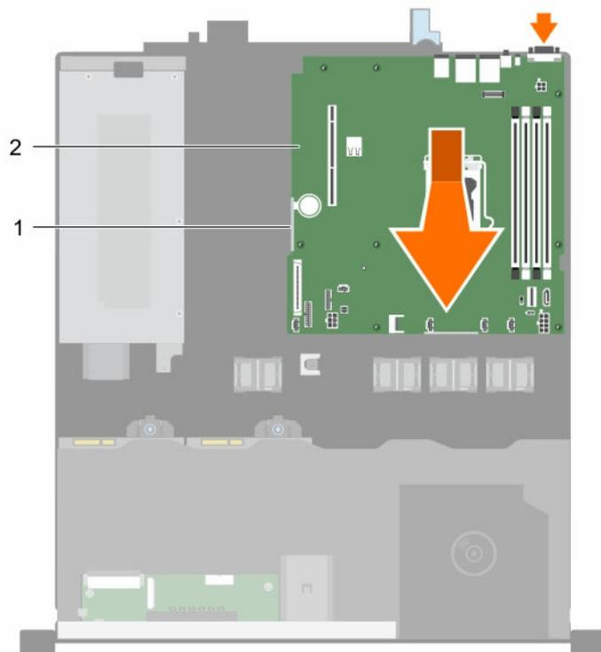
图 53: 卸下和安装系统板
