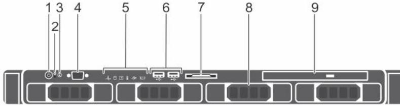
图 2: 前面板功能部件和指示灯: 四个 3.5 英寸有线硬盘驱动器机箱
