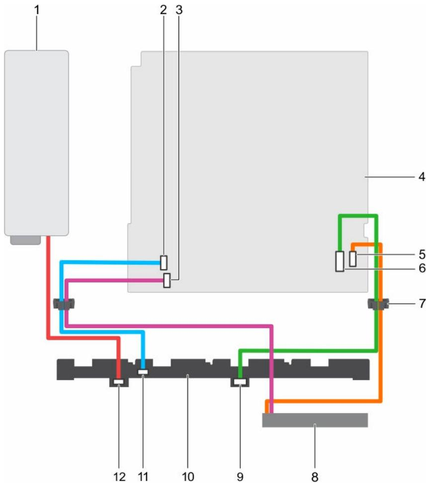
图 47: 布线图 — 四个 3.5 英寸热插拔 SAS / SATA 硬盘驱动器背板
