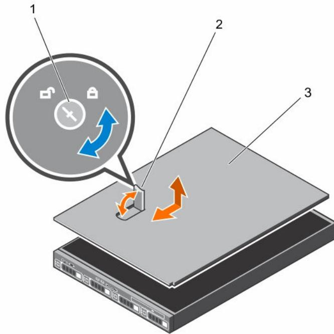
图 10: 卸下和安装系统护盖
