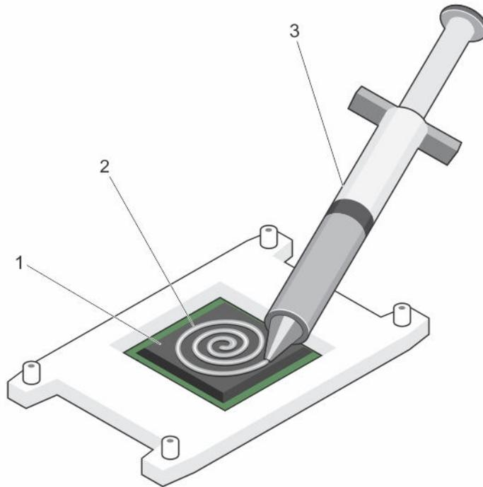
图 42: 在处理器顶部涂抹导热油脂
