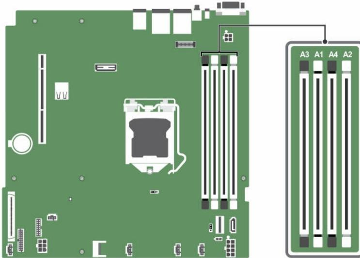
图 16: 系统板上的内存插槽位置
