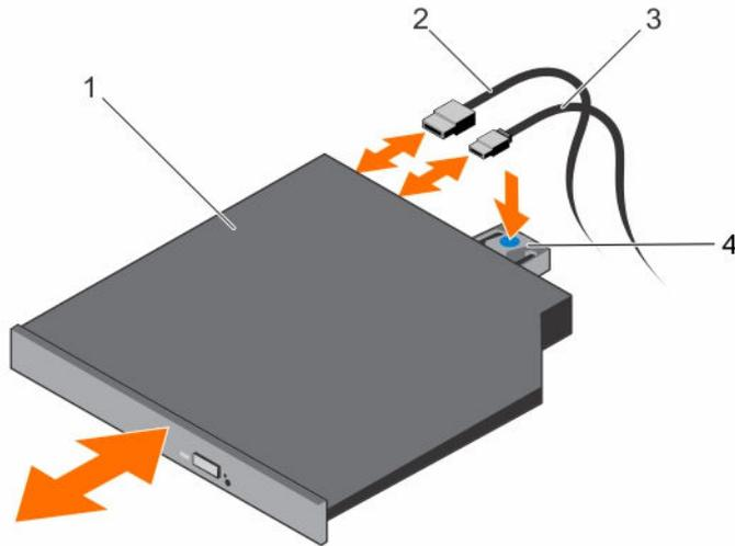
图 30: 卸下和安装光盘驱动器
