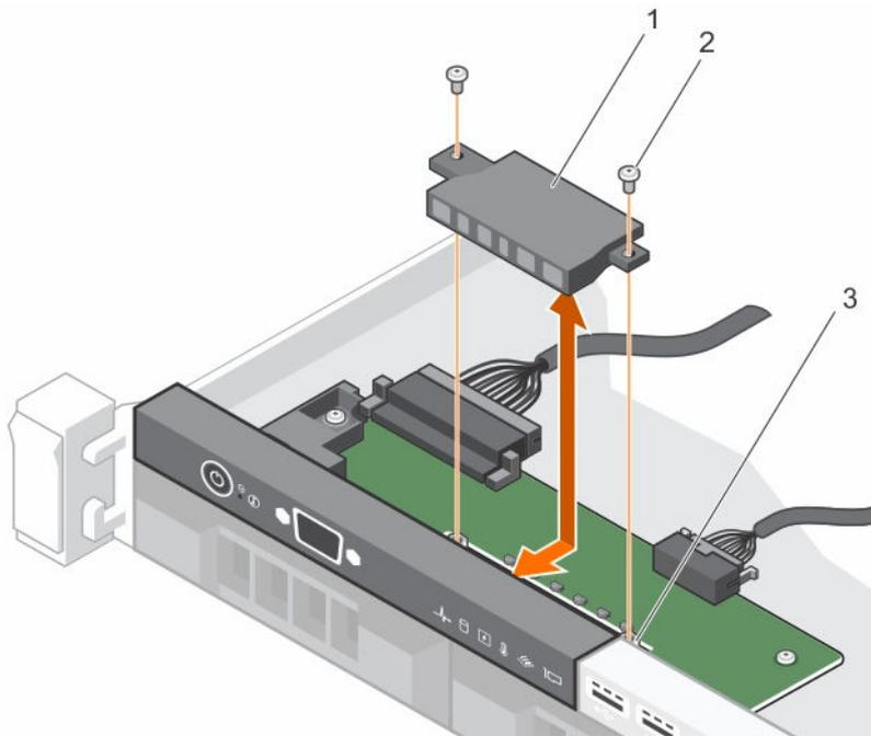
图 50: 卸下和安装 LED 模块 — 四个有线硬盘驱动器机箱
