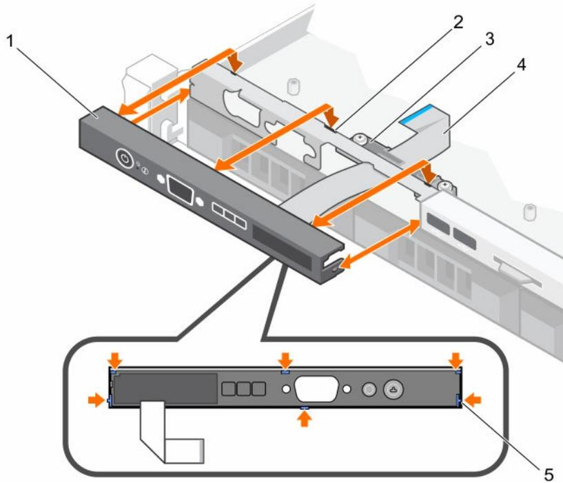
图 48: 卸下和安装 LCD 控制面板 — 四个 3.5 英寸热插拔硬盘驱动器机箱
