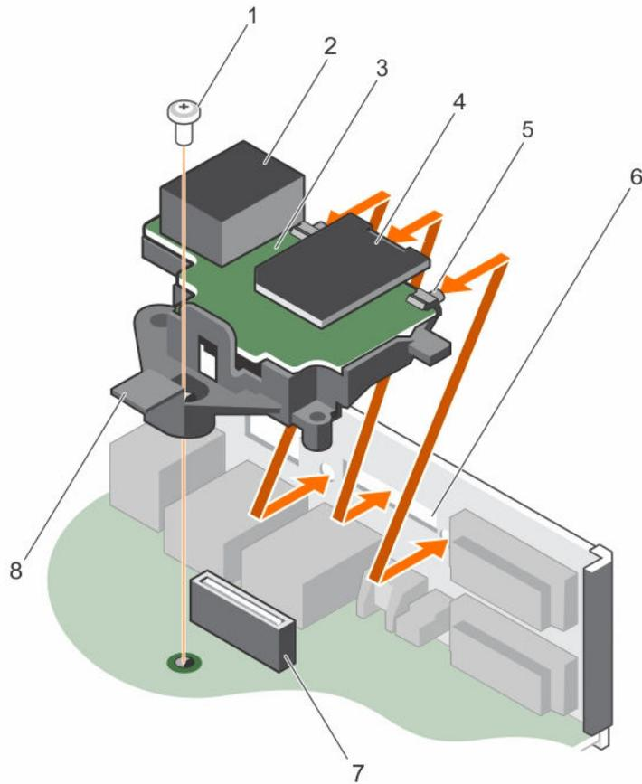
图 38: 卸下和安装 iDRAC 端口卡
