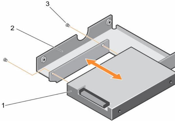
图 24: 在 3.5 英寸硬盘驱动器适配器中卸下和安装 2.5 英寸热插拔硬盘驱动器
