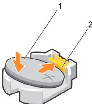
图 45: 安装系统电池
