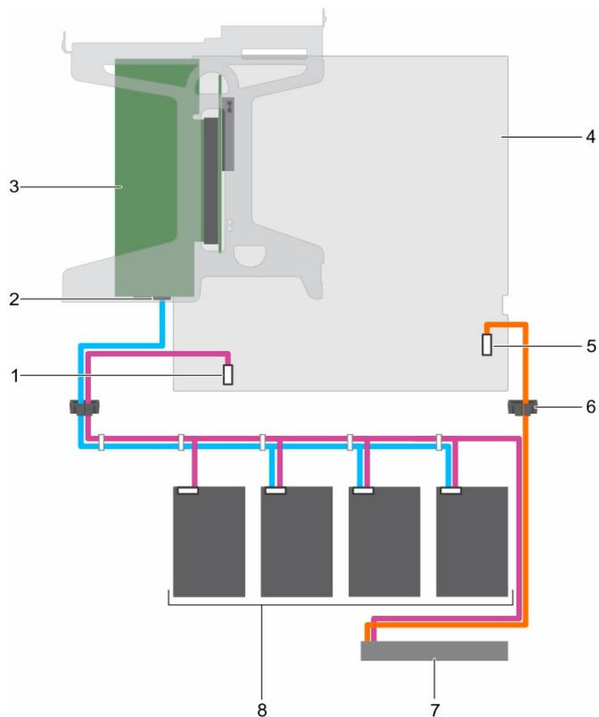
图 26: 四个 3.5 英寸硬盘驱动器布线到 PERC 卡
