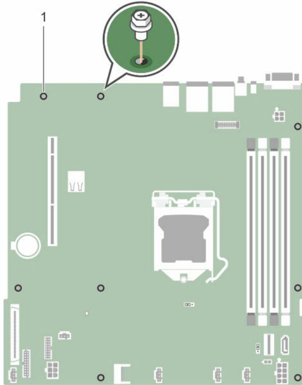
图 52: 卸下和安装系统板上的螺钉
