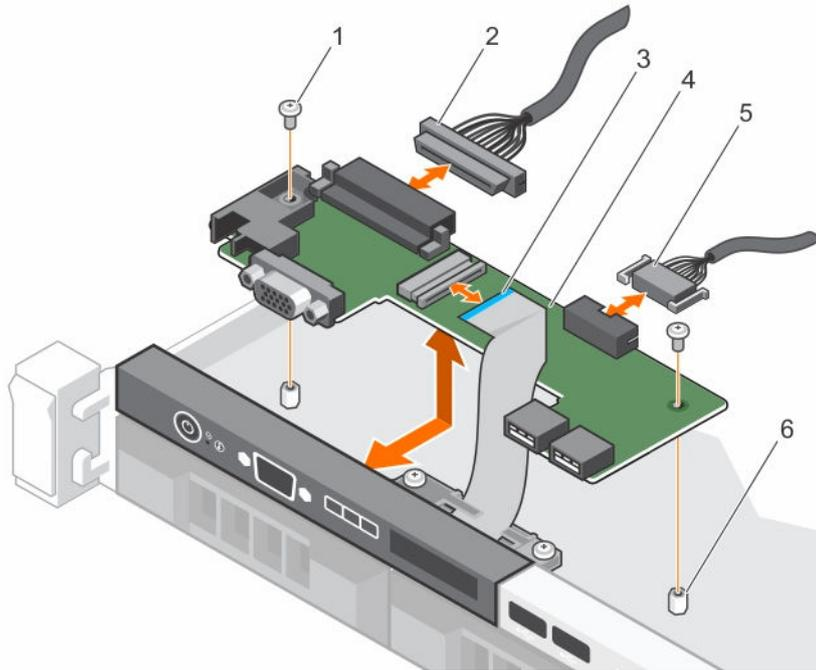
图 49: 卸下和安装 LCD 控制面板电路板 — 四个硬盘驱动器机箱
