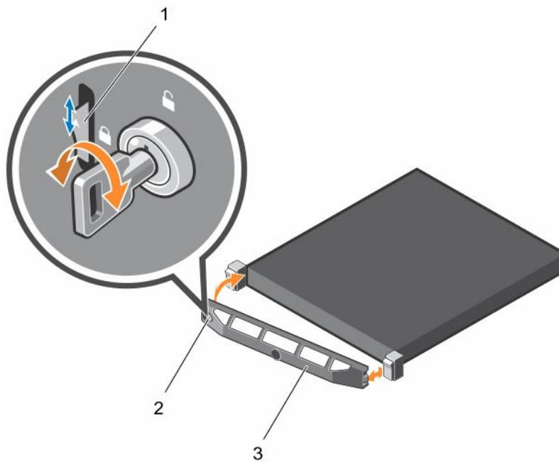
图 9: 卸下和安装可选的前挡板
