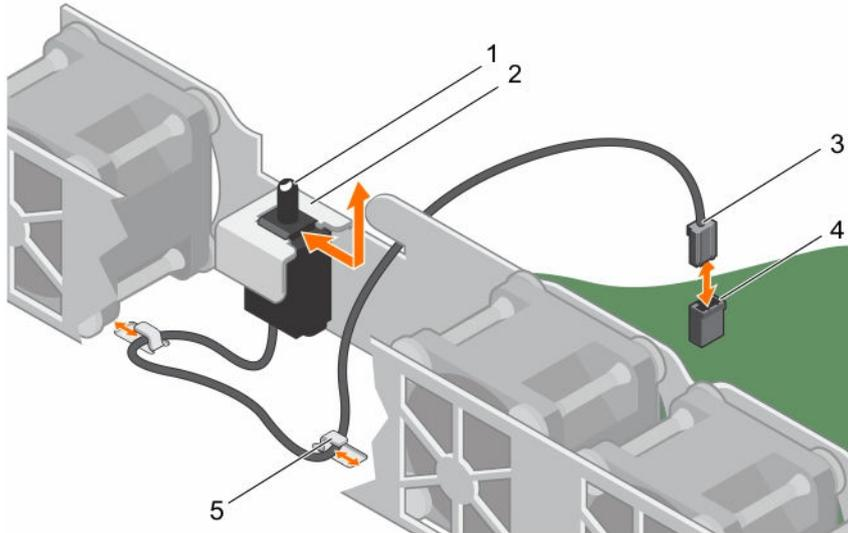
图 14: 卸下和安装防盗开关
