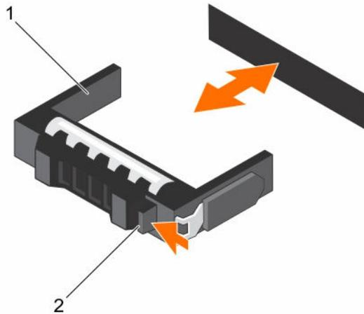
图 19: 卸下和安装 3.5 英寸热插拔硬盘驱动器托盘挡片
